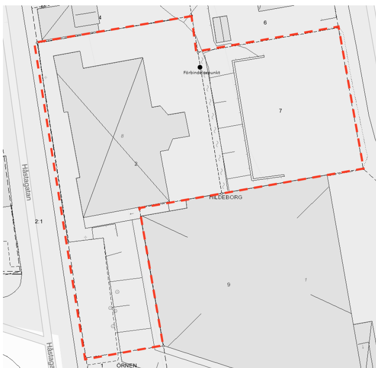
Bild 32: Förslag på ny förbindelsepunkt för dagvatten för fastighetens Hildeborg 2 dagvatten.
