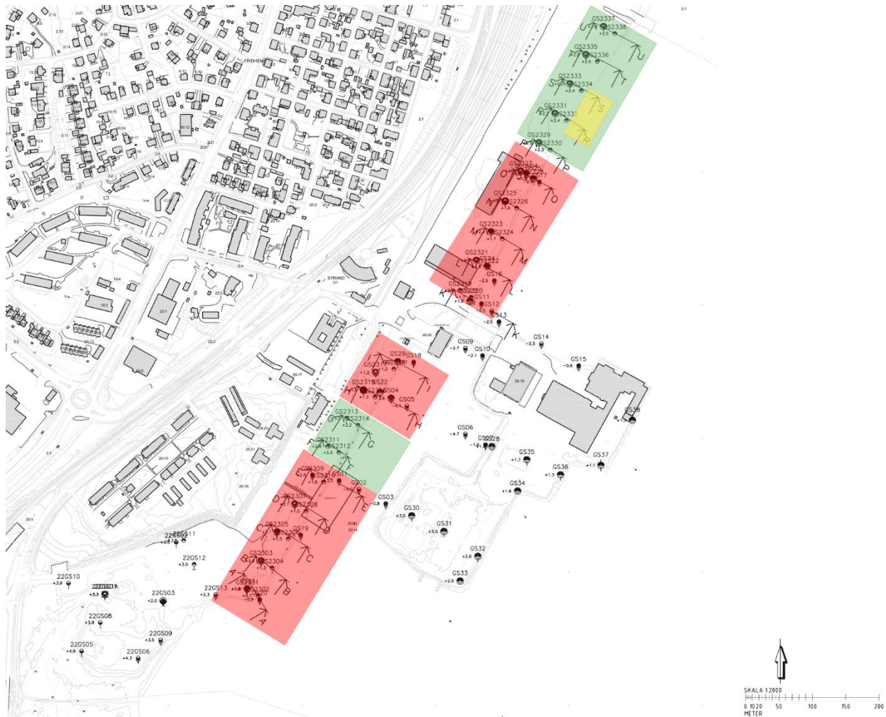
Figur 11, översiktskarta med geosektioner och färgkodad visualisering av stabilitetsförhållanden m.h.t. detaljplanen [22]. En högupplöst version finns i Bilaga 2.
