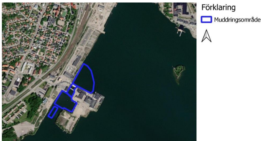
Figur 6. Översikt över områden med utförd sugmuddring av bottensediment i entreprenaden Miljösanering Håstaholmen etapp 2 mellan åren 2019-2021. (Structor, 2021)
