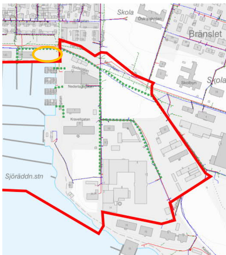
Figur 11. Befintliga ledningar inom detaljplanområdet. Dagvattenledningarna är markerat tydligare i grönt och detaljplanområdet markerat i rött. Området där Hudiksvallskommun planerar reningsanläggning för dagvatten
