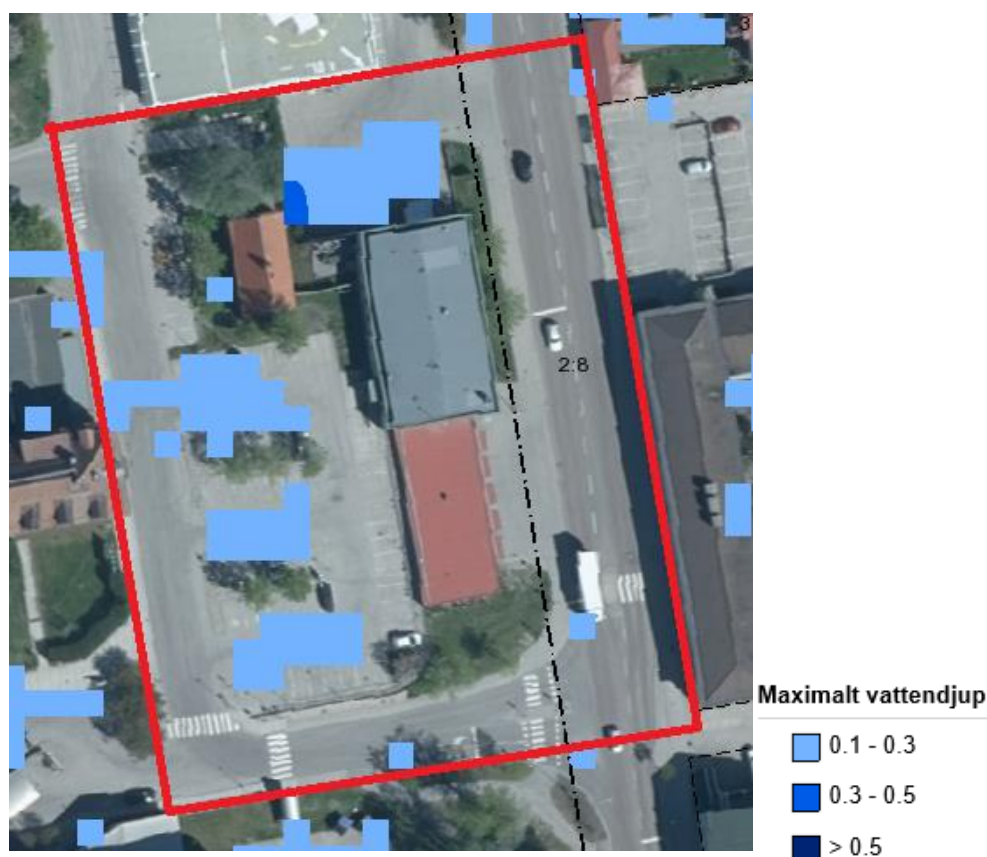
Bild 11: Översiktlig bild för planområdet vid skyfall enligt Hudiksvalls kommuns skyfallsanalys
