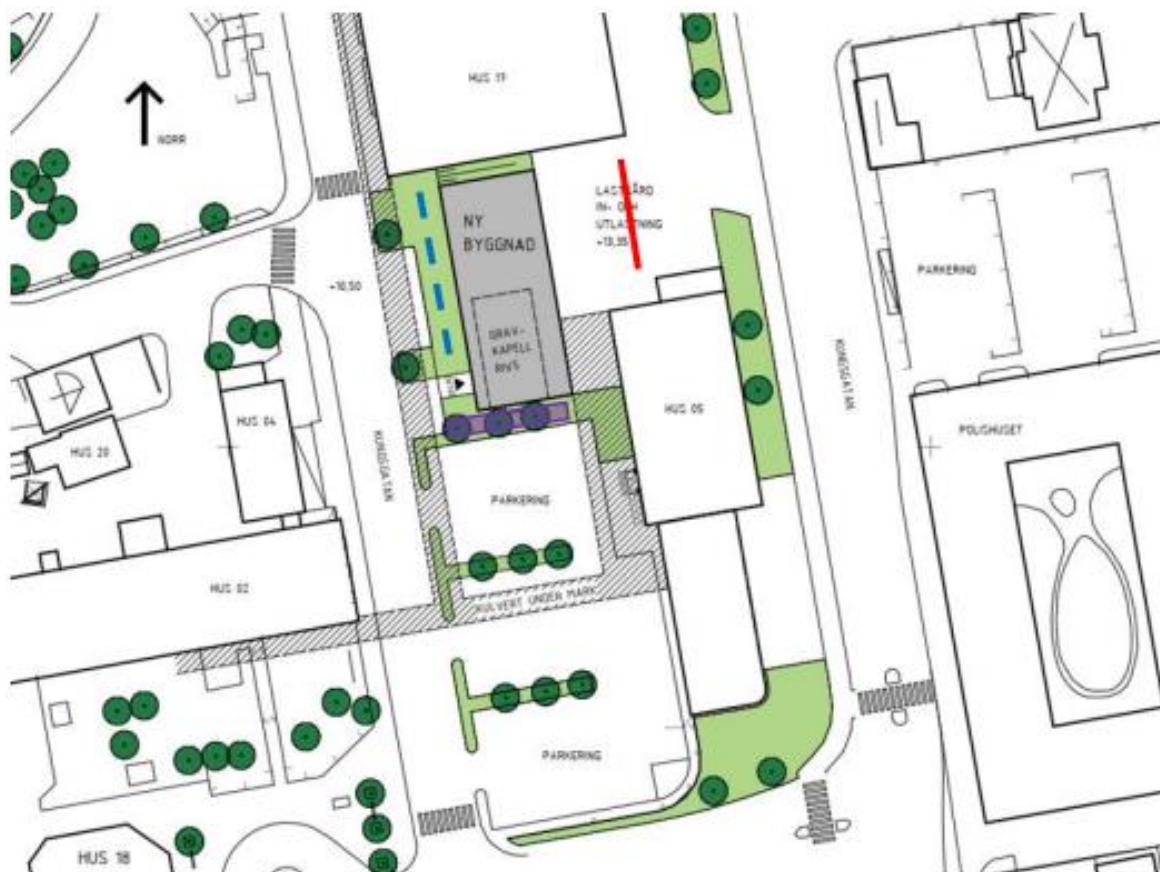
Bild 18: Planförslag dagvattenlösning. Blå streckad linje visar på placering av svackdike, röd linje visar placering av rörmagasin och lila markerad yta visar placering av växtbäddar (Illustration dagvattenutredning WSP)
