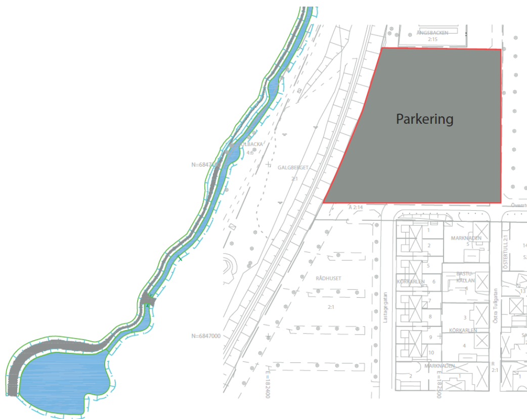
Figur 5 Illustration över dagvattendammen som är tänkt att ta hand om vattnet från parkeringsplatsens diken.
